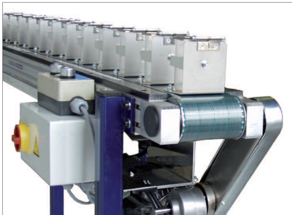
HAVER AS 12, Autosampler mit 12 Bechern für die automatische Beschickung eines Photooptischen Partikelanalysegerätes HAVER CPA
